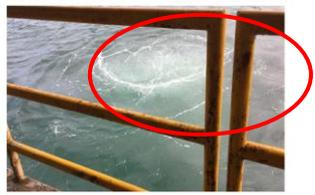
Fuga de gas en lado S-E de Plataforma SS por rotura de línea 3 1/2" circuito gas lift PN5-SS
