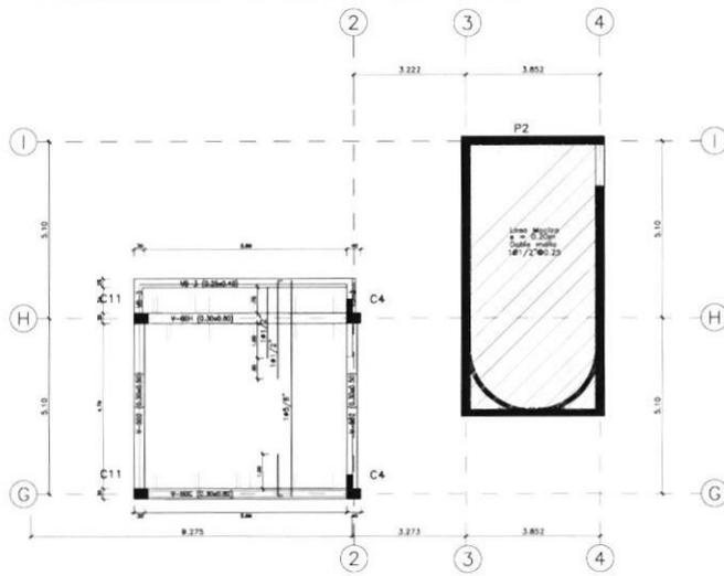
PLANTA DE ENCOFRADO AZOTEA
