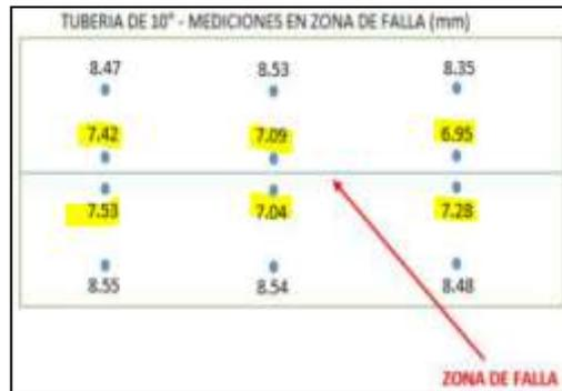
Asimismo, la medición de espesores por micrometro, unicamente demuestra que, alrededor de la junta de fabricación tambien hubo perdida de metal generado por la corrosión externa; toda vez que, dicha medición indica menor espesor (0.317 pulgadas y 0.319 pulgadas), mientras esta mas cerca a la zona de falla (junta de fabricación):
