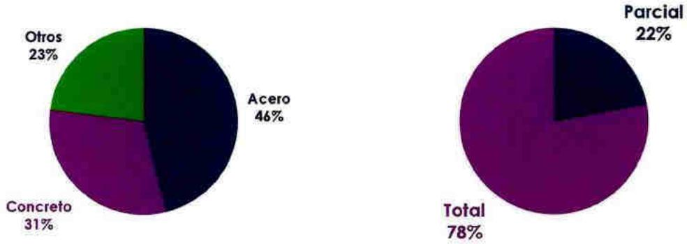
(a) Tipos de materiales de los puentes que fallaron debido al viento extremo (17 fallas)
