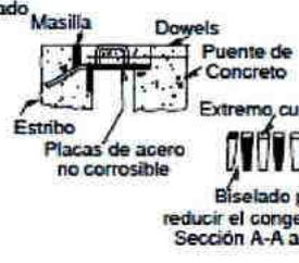
(f) LOSA FLOTANTE PARA EXPANSIONES PEQUEÑAS
