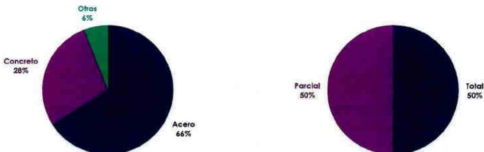
(a) Tipo de material de los puentes fallidos debido a socavación (200 fallas). (b) Tipo de falla debido a socavación (200 fallas)
