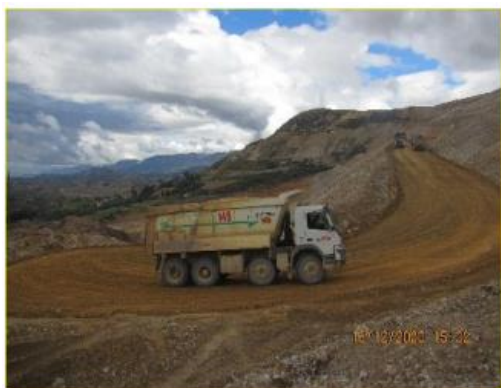
Fotografía 26. Vista de los camiones volquetes trasladando el material (desmonte y/o mineral), las tolvas no se encuentran cubiertas con mantas 166 .
