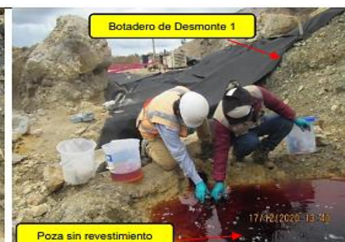
Fotografía 46. Vista de la toma de muestra del efluente del depósito del Botadero de Desmonte 1, que discurre sobre una poza sin revestimiento.
