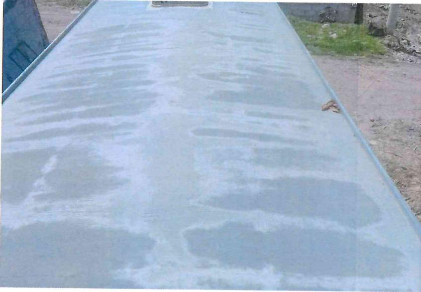
FOTOGRAFIA N° 02. SE OBSERVA EL DETERIORO DEL TECHO DEL BUS EGI-682
