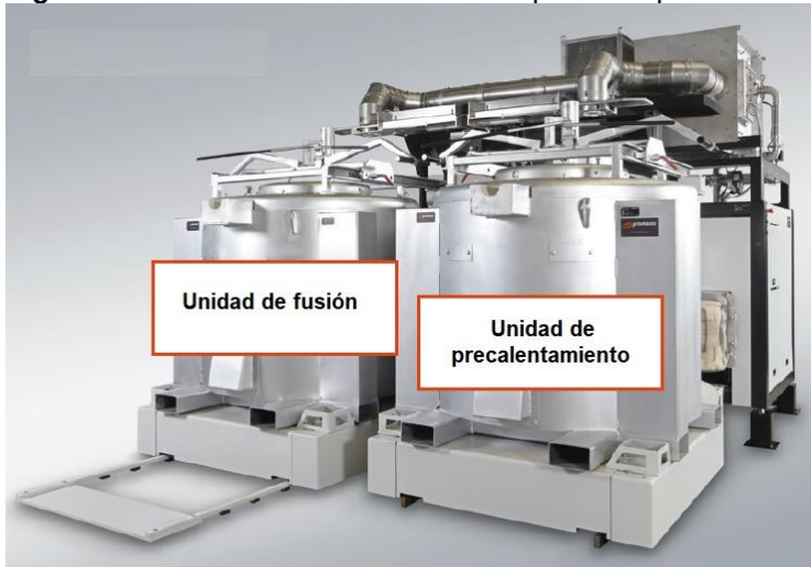
Figura 16. Horno de crisol de doble olla para recuperar calor
