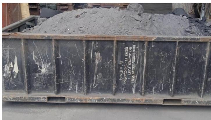
Figura 6. Contenedor con arena residual de moldeo
