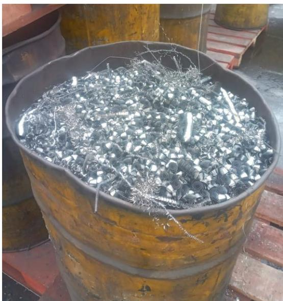
Figura 4. Viruta mezclada como material de descarte
