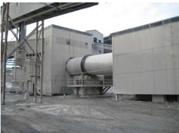
**Figura 12.** Máquina que seca los núcleos de arena triturados y clasificados
