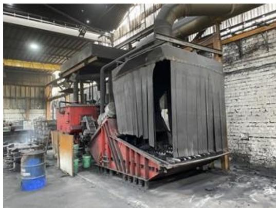
Figura 9. Sistema de recuperación de arenas de moldes
