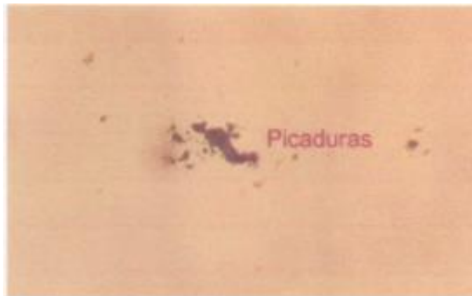
Foto N°8.- La microestructura del material del muñón averiado del cigüeñal presenta picaduras (puntos negros pequeños de las fotos A y B) y huecos en la zona de fractura (Sin ataque Químico).100X
