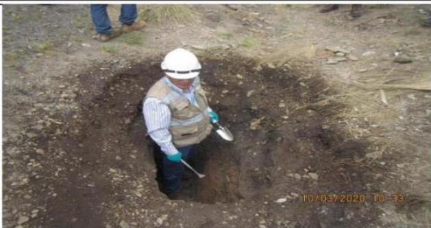
Foto N° 1.- Área con presencia de hidrocarburo, ubicado a la margen izquierda de la vía Arequipa – Juliaca, aproximadamente a 1.5 metros de la pista en un área aproximada de 2 m2, donde la empresa realizó un agujero.
