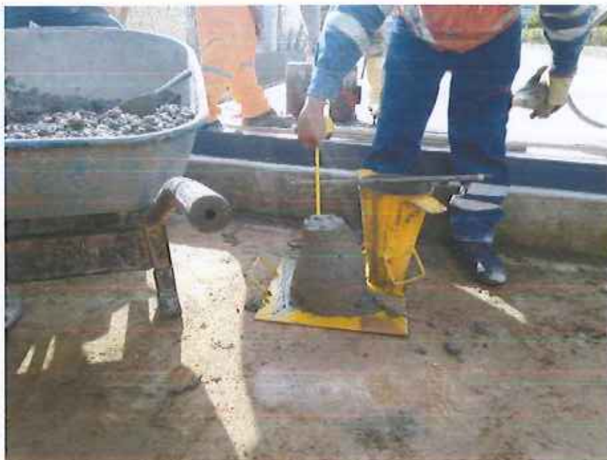
Verificación de slump del concreto
