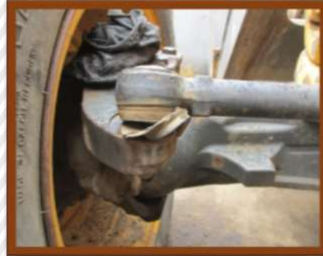
TERMINAL DE DIRECCIÓN DESGASTADO
