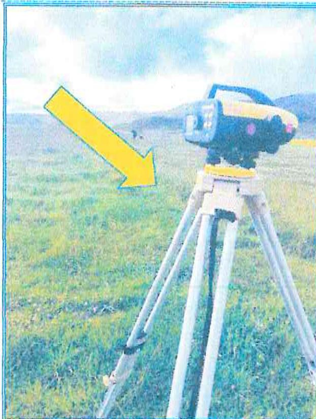
IMAGEN 09: SE OBSERVA LA NIVELACION CON NIVEL ELECTRONICO SPRINT 250 LEICA
