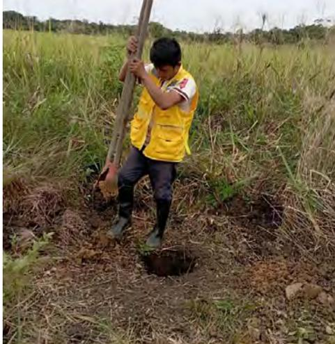
*Proceso de excavación de calicatas para prueba de percolación*
