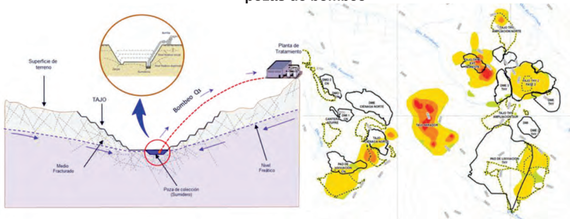
Figura Obs 22d-4: Esquema conceptual intercepción del nivel freático por pozas de bombeo
