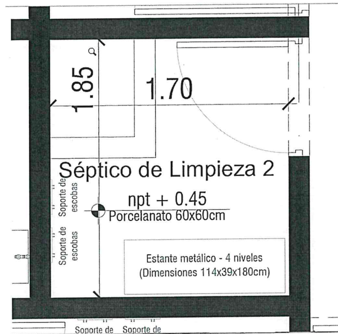
Figura 56. Dimensión del séptico de limpieza
