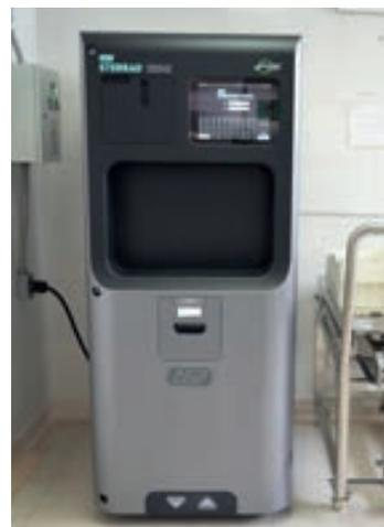
Esterilizador a baja temperatura por Peróxido de Hidrógeno
