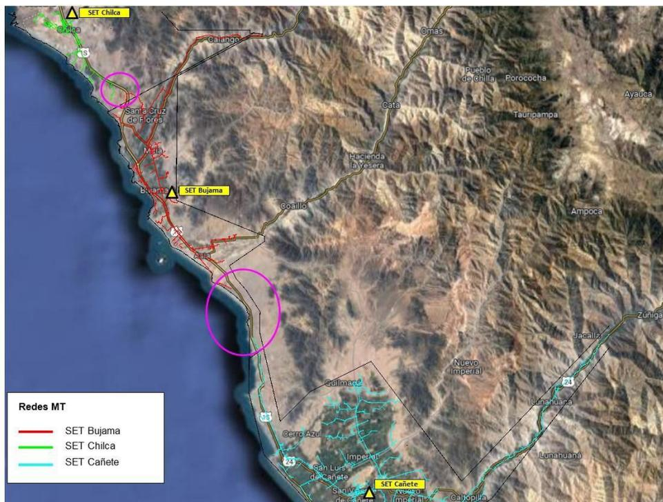
Respecto a la carga en 22,9 kV atendida por el transformador 2 de la SET Bujama, la posibilidad de transferirla a través de las redes de 22,9 kV hacia las SETs colindantes Chilca y Cañete no es factible, debido a las distancias que existen entre las redes en dicho nivel de tensión, que son de aproximadamente 28,0 y 38,8 km respectivamente.
