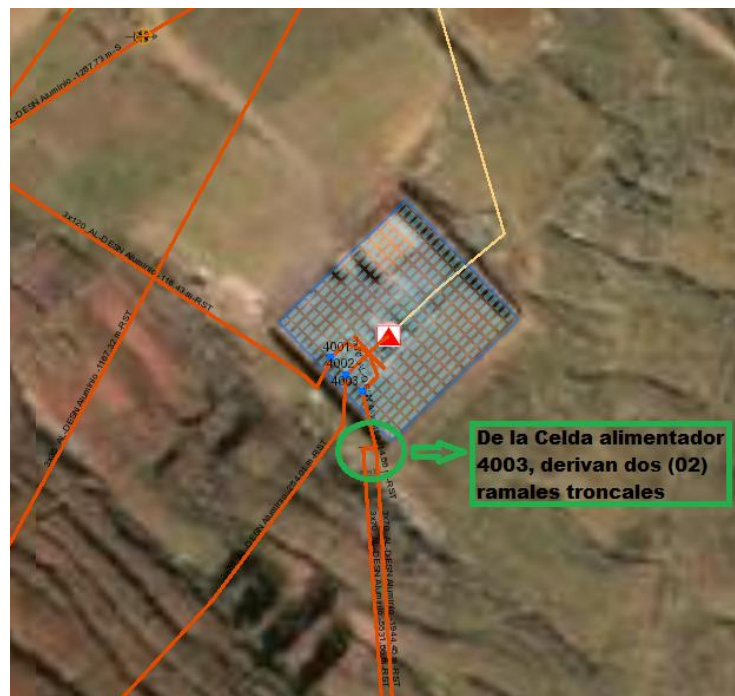
Figura 5 Configuración del alimentador 4003 de la SET Huancané
