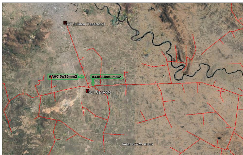
Figura 9 Topología del circuito 5025 proveniente de la SET Juliaca
