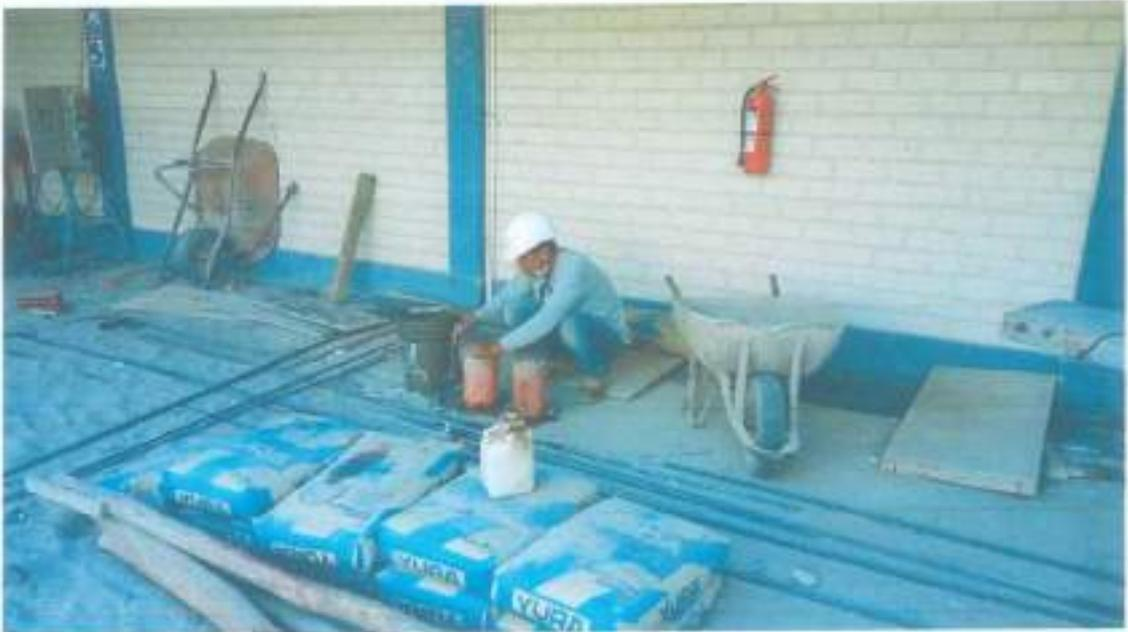
PROBETAS PARA PRUEBAS DE RESISTENCIA DEL CONCRETO
