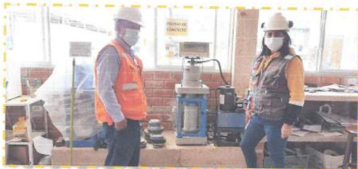
Fotografía N° 18: se verifica la rotura de probeta de concreto en el laboratorio, con la finalidad de obtener resultados confiables sobre la resistencia del concreto utilizado en obra.
