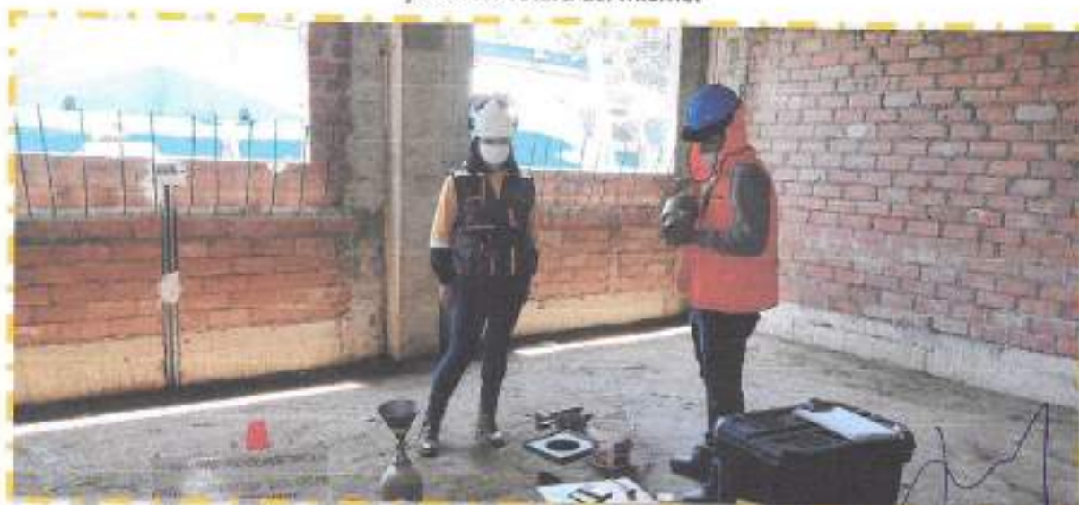
Fotografía N° 19: la supervisión verifica la obtención del contenido de humedad de la muestra con el método Speedy.
