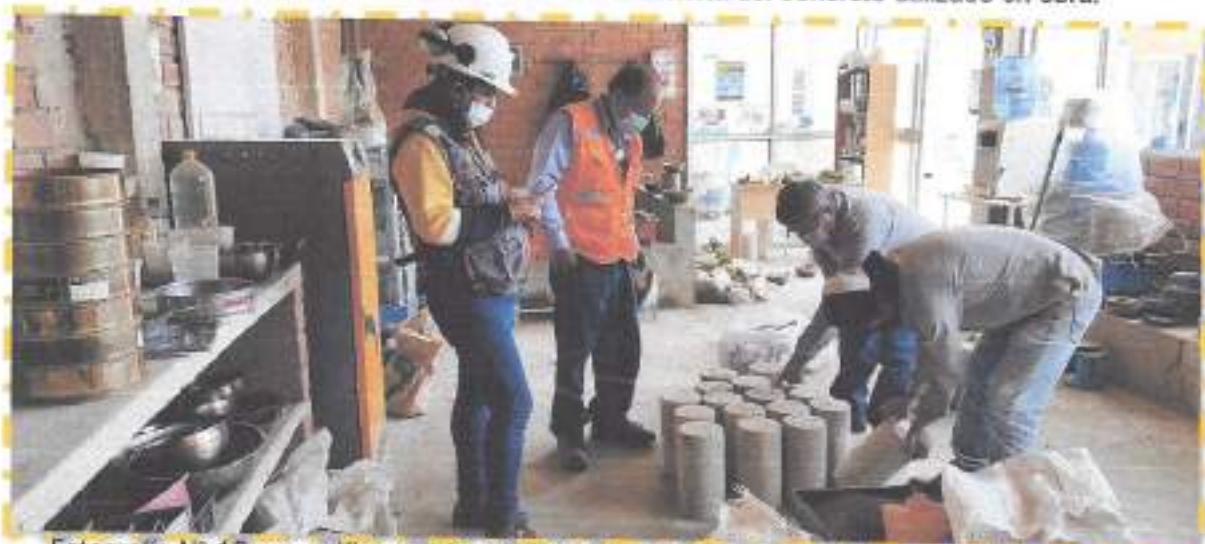
Fotografía N° 19: se verifica que las probetas se encuentren en optimas condiciones para su posterior rotura del mismo.
