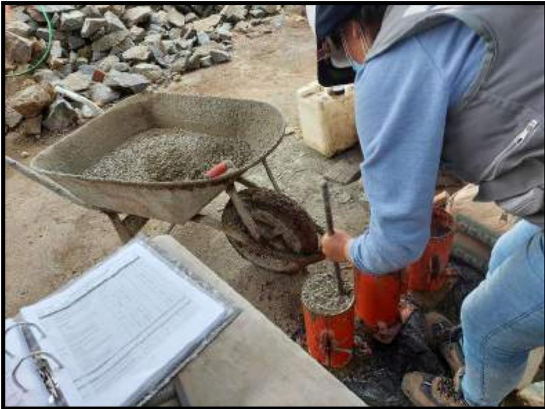
VERIFICACION DE LA TOMA DE MUESTRAS DEL CONCRETO UTILIZADO EN FALSAS ZAPATAS PARA SU POSTERIOR ANALISIS.
