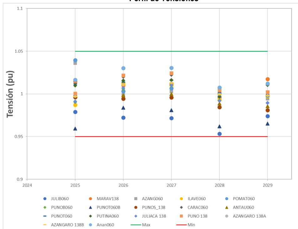
De la gráfica anterior, se observa que las barras analizadas cumplen con las tolerancias establecidas en la Norma Técnica de Calidad de los Servicios Eléctricos (NTCSE) en el período 2025-2029.
