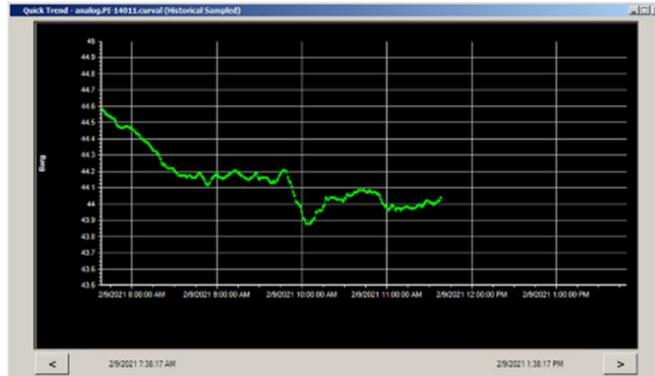
Figura N° 2: Presión de Ingreso ERP Maquinarias 50/19 BARG
