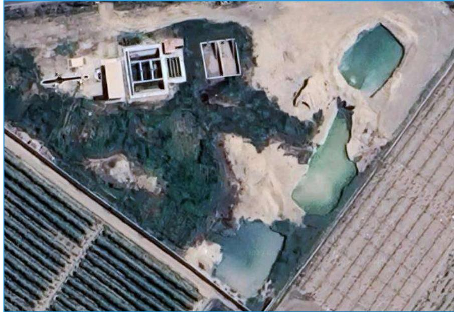
Dentro del sector en mención existe un tratamiento adicional correspondiente al C. P. Tiwinza; de tipo tanque séptico, el cual se considera parcialmente operativo debido a la obstrucción de uno de sus buzones de infiltración (se encuentra bajo escombros), de igual manera dentro del diagnóstico realizado se considera que por su baja operatividad es necesario canalizar las aguas residuales hacia la PTAR “Belén”.
