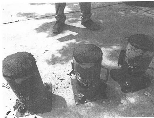
PROBETAS DE CONCRETO 210 KG/CM<sup>2</sup> PARA VIGAS DE CIMENTACIÓN.
