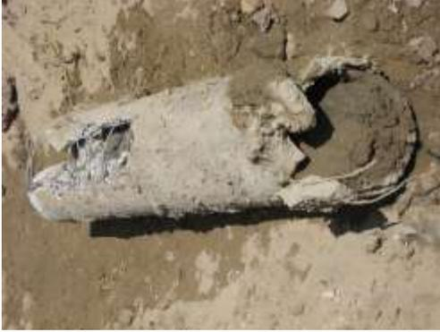
Tuberías de agua y desagüe colapsadas
