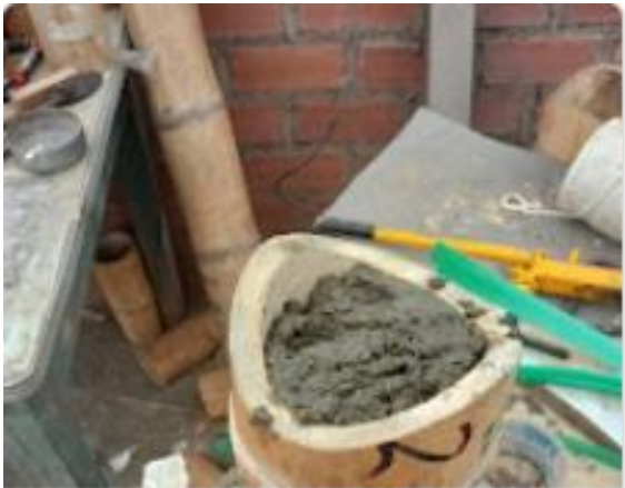
Se observa uniones preparadas con las piezas de bambú, sin refuerzo de zunchos, antes de ser ensayadas, así como el llenado de mortero grueso 1:4 dentro de las uniones y los tacos de madera eucalipto a ser empleados en las uniones colineales.
