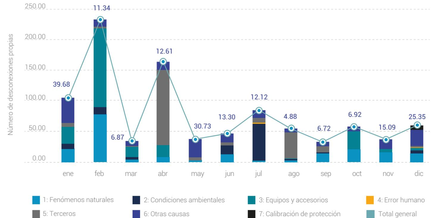
Gráfico 56. Duración de desconexiones en líneas de transmisión [60-500] kV de enero a diciembre del 2018.
