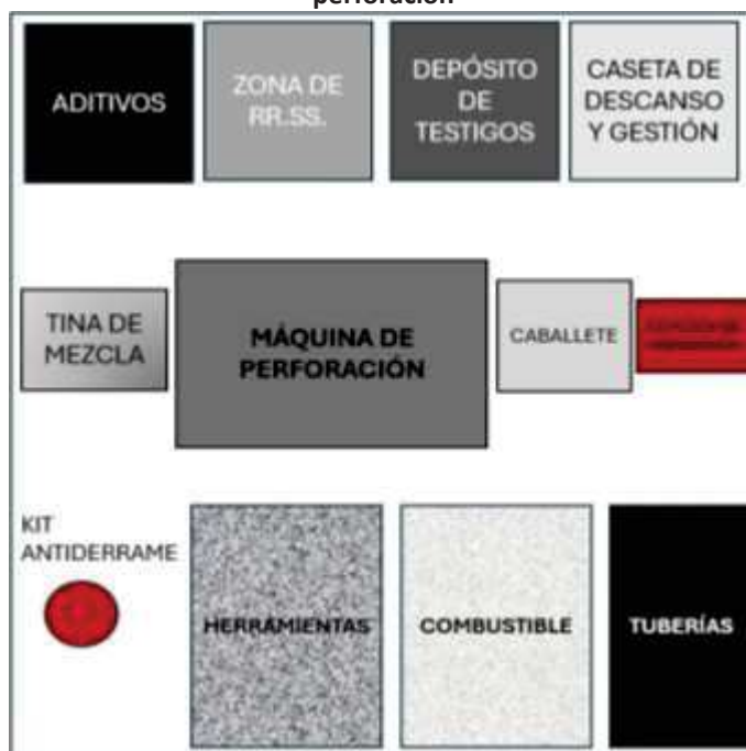
Figura N° 1 Vista referencial en planta de la plataforma de perforación
