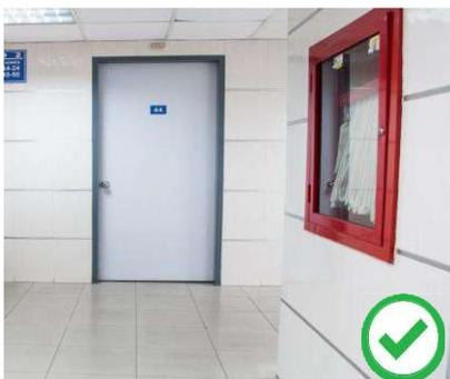
Si los elementos adosados sobresalen 0.15 m, se debe prolongar el objeto hasta el suelo o colocarse debajo del objeto algún elemento que sea detectable con un bastón, pudiendo ser un tope o resalte de manera fija de altura comprendida de 0.10 m a 0.30 m o identificado con señalización podotáctil.
