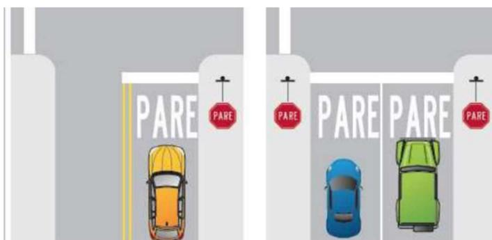
Es una línea transversal a la calzada o superficie de rodadura que tiene por función indicar al Conductor que debe detener completamente el vehículo, el cual no debe sobrepasar el inicio de la indicada línea.
