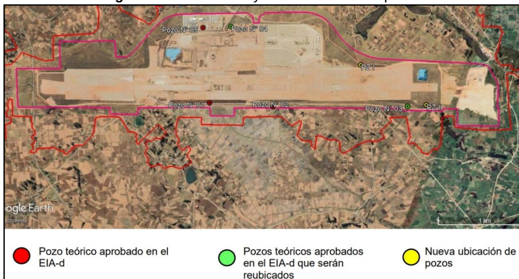
Figura N° 1: Ubicación y reubicación de los pozos
