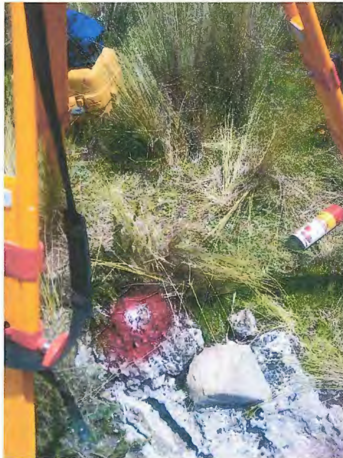
Foto 06: Pintado sobre roca del BM-2 además es la estación base del equipo topográfico.
