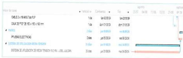
Como se puede apreciar la partida **04.13.01 Sistema de Utilización de Media Tensión 13.2 KV – UGEL** se encuentra en ruta crítica y se ve afectada en el periodo entre el 01-08-2024 al 21-08-2024 (la obra está suspendida desde el 22-08-2024).
