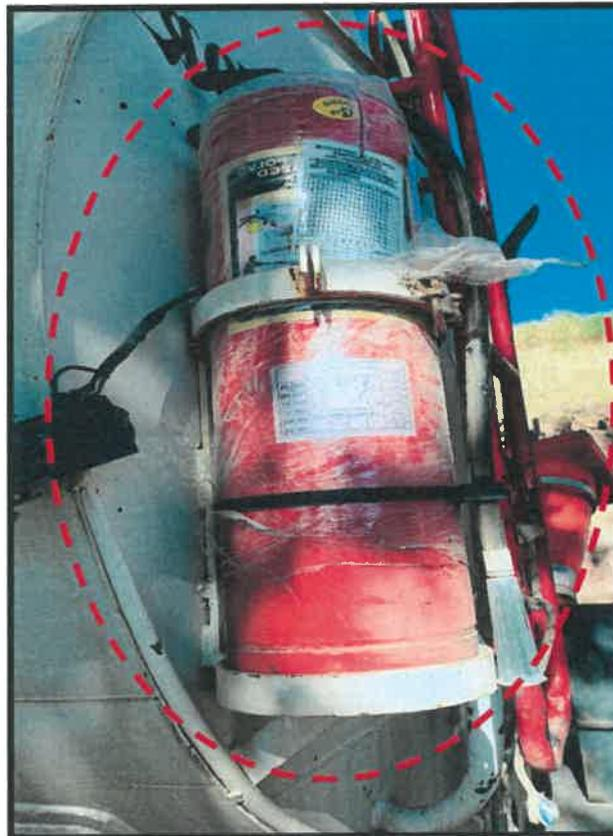
De la fotografía N° 11 se observa que en las etiquetas del extintor no cuenta con fecha vigente, por lo que se evidencia que el responsable SSOMA no viene cumpliendo en inspeccionar los extintores.
