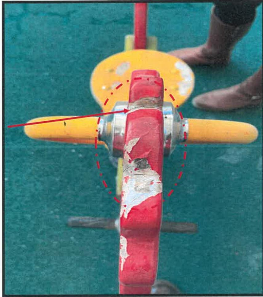
**Imagen 14:** se observa rajadura y agujero en la cabeza del balancín.
