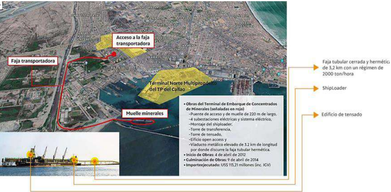
Figura 83. Infraestructura del Terminal de Embarque de concentrados de Mineral
