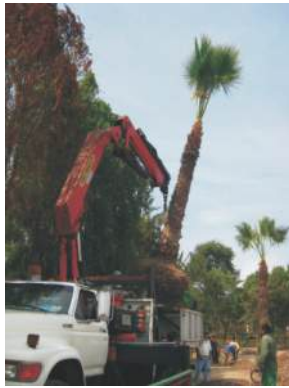
Fig. 5. Traslado de palmeras en la carrocería del vehículo con la pluma hidráulica.
