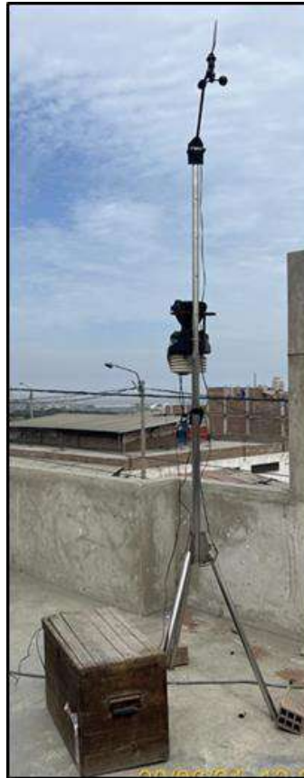
Figura 6. Estación meteorológica de la marca Davis instalada
