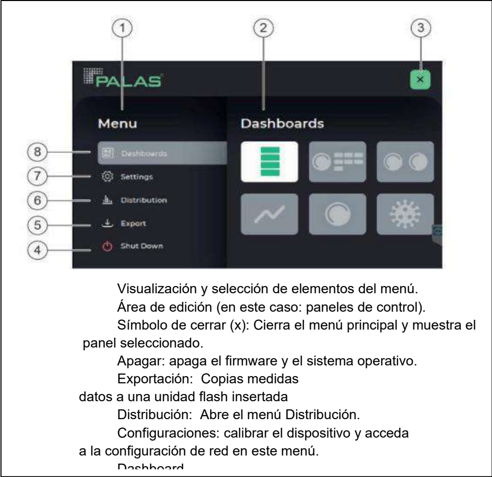
Figura 5. Menú Principal del equipo PALAS Fidas Smart 100E
