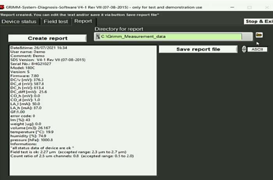
Figura 65. Creación del reporte de verificación con el Field Test
