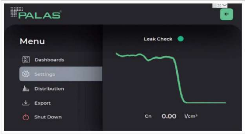
Figura 17. Verificación de fugas aprobada del Equipo Fidas Smart 100E
