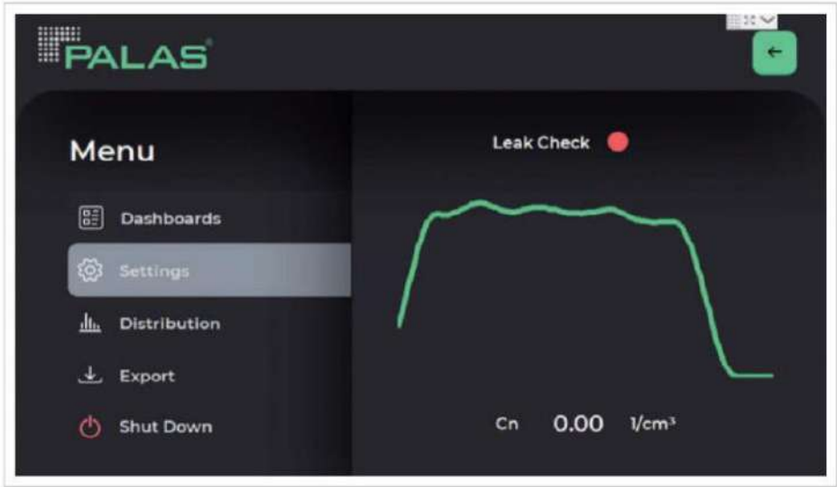
Figura 15. Estabilización de la comprobación de fugas del Equipo Fidas Smart 100E.
