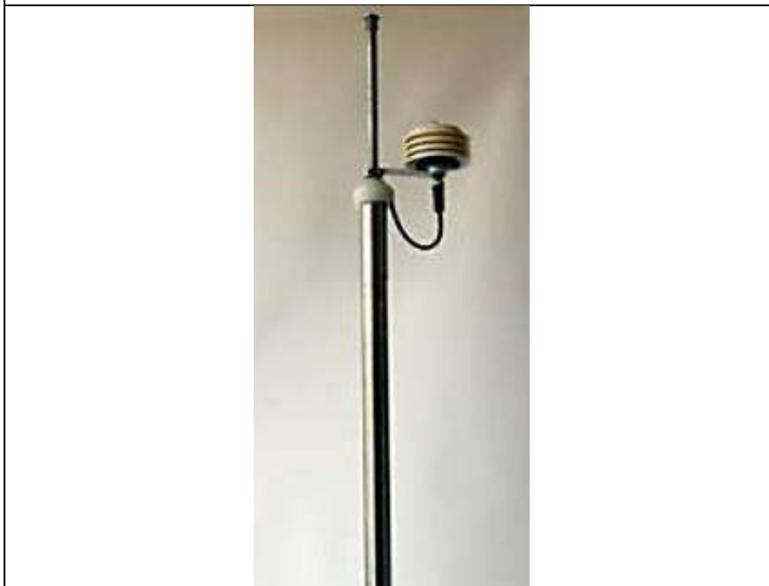
Figura 3. Tubo de muestreo, Sensor de Temperatura Ambiental y Humedad Relativa
