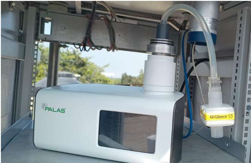
Figura 23. Equipo Fidas Smart 100E con filtro HEPA
