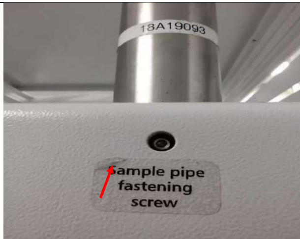
Figura 81. Muestra del “sample pipe fastening screw” o tornillo de fijación.
