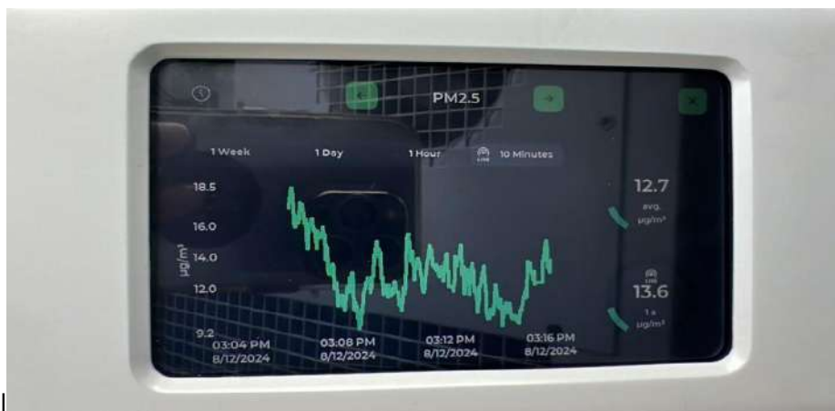
Figura 8. Panel de control con valores medidos en bloques en el Equipo Fidas Smart 100E
