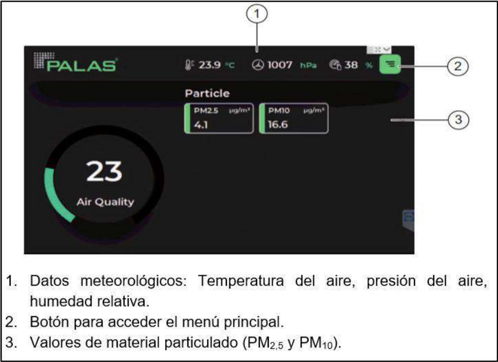
Figura 7. Panel de control con valores medidos en bloques en el Equipo Fidas Smart 100E
