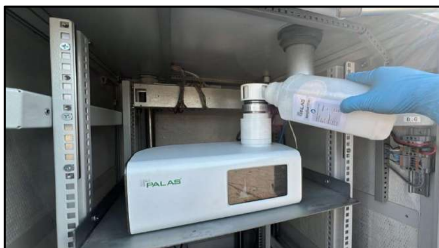
Figura 24. Verificación del Equipo Palas marca Fidas Smart 100E con MonoDust 1500
