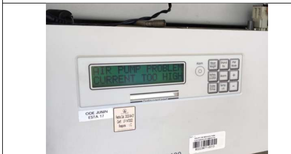
Figura 46. Mensaje de alerta en la pantalla durante las pruebas de fugas
