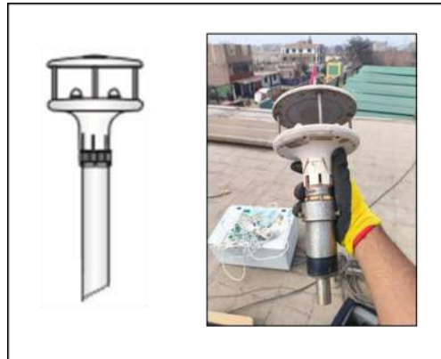
Figura 5. Montaje del Anemómetro en mástil
