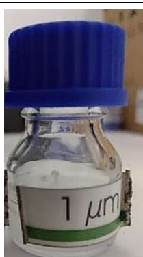
Figura 56. A) Frasco para preparación de suspensiones de látex. B). Concentrados de látex monodisperso de 1 \mu\text{m} C) Depósitos para inyección continua en atomizador.
