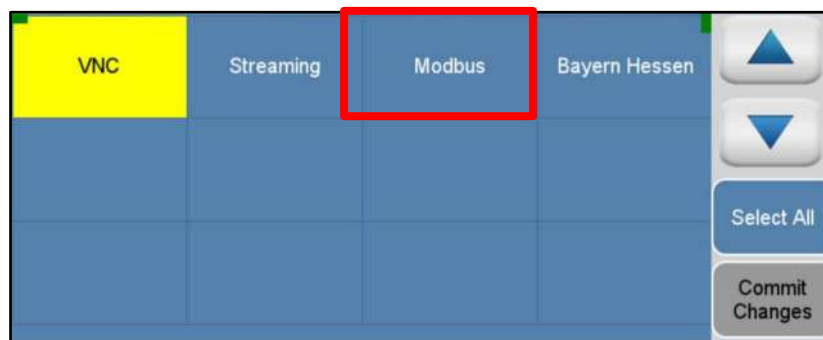
Figura 6. Habilitar opción Modbus en los analizadores
