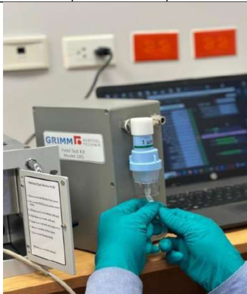
Figura 58. Acoplamiento de depósito en FTK 185
