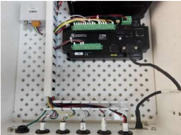
Figura 2. Sensor y data logger de la estación meteorológica marca Campbell
