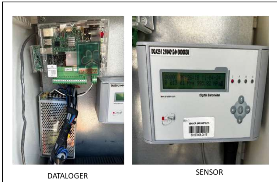
Figura 2. Data Logger Maigrai (modelo RAI-M02) y sensor barométrico
