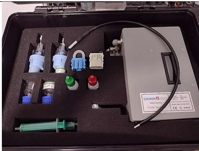
Figura 56. A) Frasco para preparación de suspensiones de látex. B). Concentrados de látex monodisperso de 1 \mu\text{m} C) Depósitos para inyección continua en atomizador.
