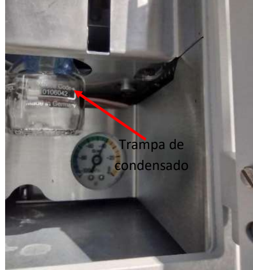
Figura 80. Frasco de vidrio o trampa de condensado
