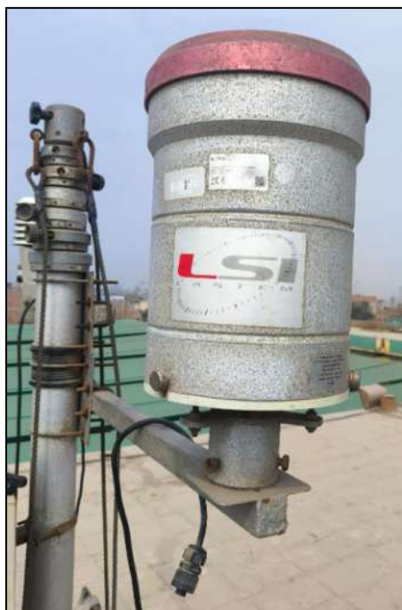
Figura 10. Instalación del pluviómetro
