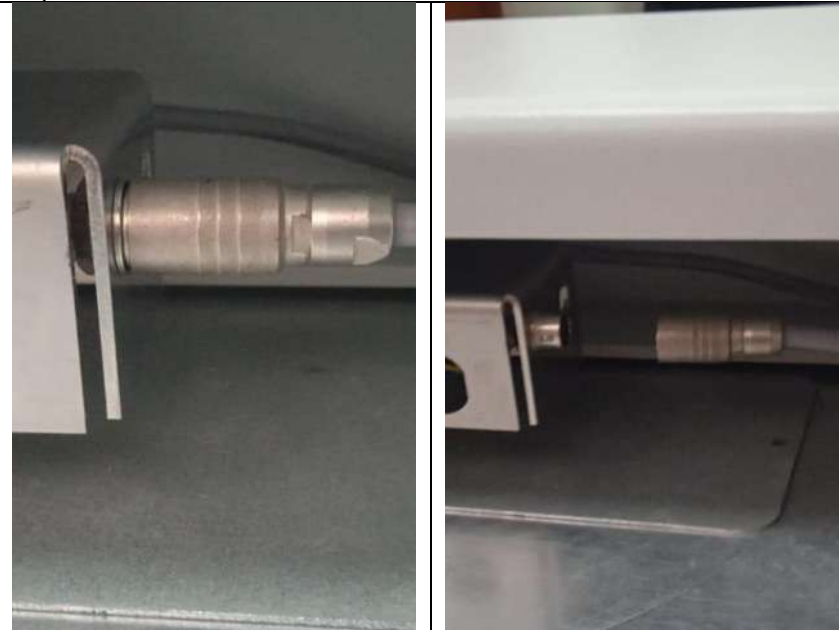
Figura 83. Desconexión de cable del sensor de clima del socket del soporte.
