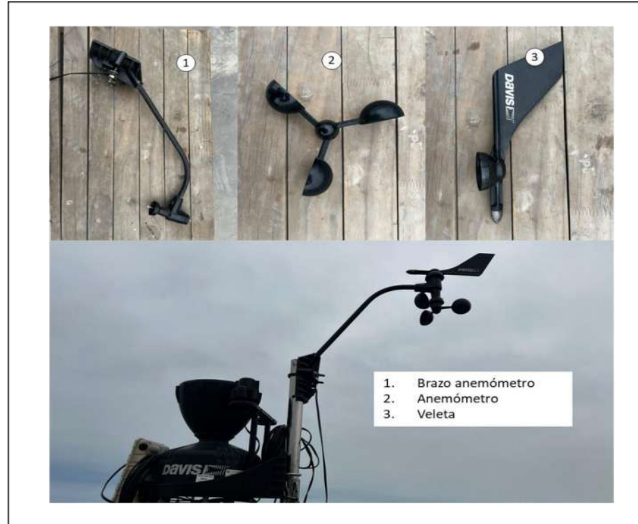
Figura 4. Sensores de velocidad y dirección de viento
