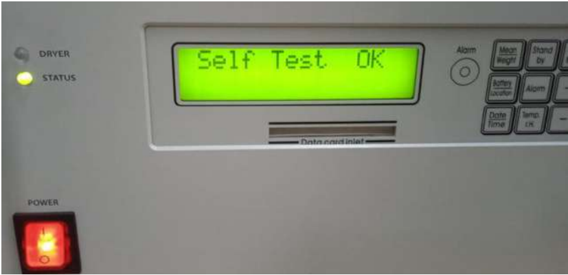
Figura 16. Equipo encendido con secuencia de AutoTest satisfactoria
