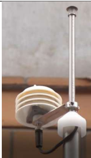
Figura 5. Sensor de Temperatura y humedad instalado en el tubo de muestreo
