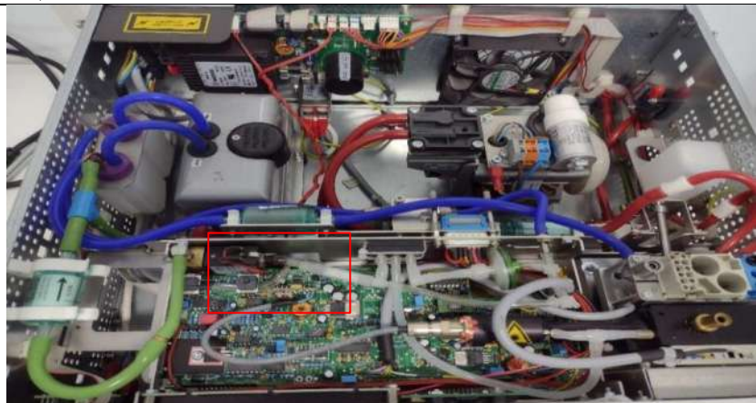
Figura 84. Descubierta de tapa mayor de monitor y ubicación de filtro BQ
