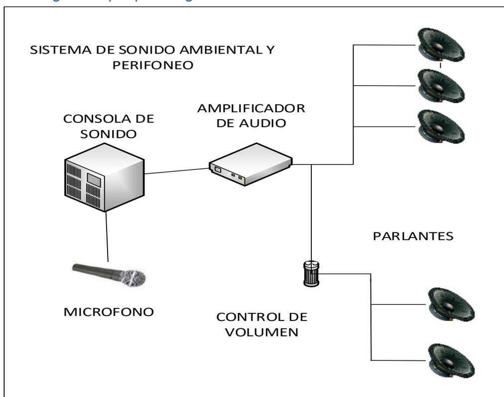
Ilustración 9. Esquema lógico del sistema de Telefonía IP, Sonido Ambiental y Perifoneo.
