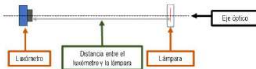
Figura: Esquema de medición de Intensidad Luminosa e Iluminancia.
