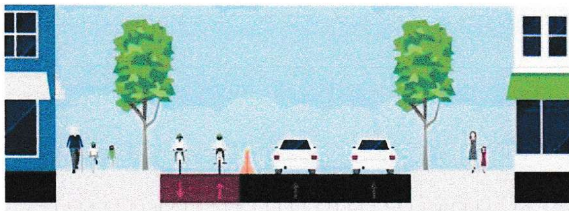
Ilustración 65: Ciclovía bidireccional ubicada al lado izquierdo
