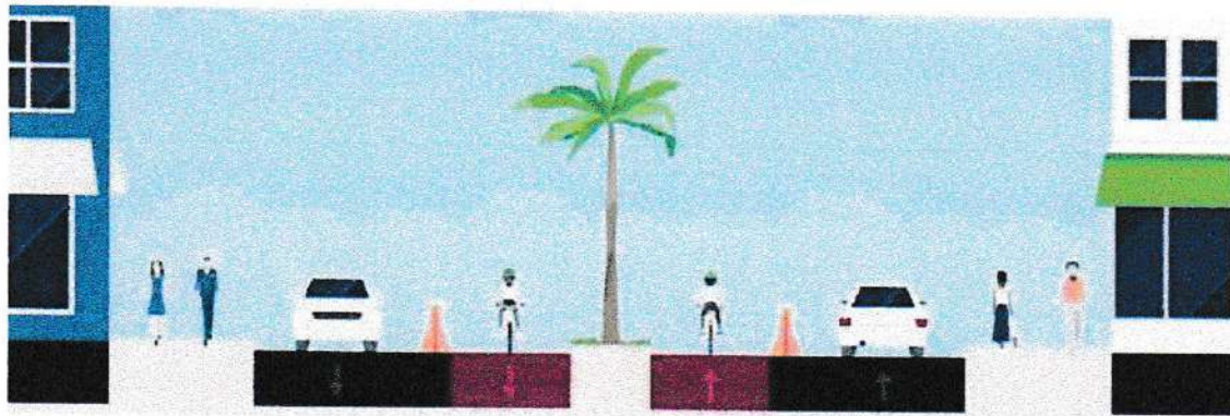
Ilustración 66: Ciclovías unidireccionales en posición central
