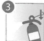
3 Presione la palanca para esparcir el químico. La persona debe ubicarse a una distancia aproximada de 2.5 m del fuego. Si se deja de oprimir la palanca, la descarga se detiene.
