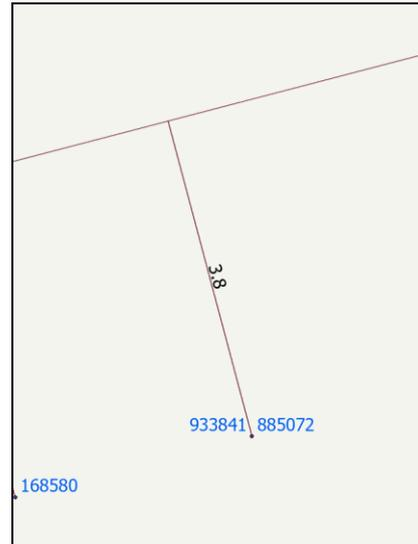
La Imagen N° 7 corresponde a la ciudad de Huaraz, en el Pasaje Las Fucsias. En campo, se identificó que la longitud total de la Tubería de conexión es de 3,10 m. (lo cual considera el ancho de la vereda, distancia al eje de la red común, altura de la vereda, altura al gabinete y profundidad de la tubería) y la empresa al reportar su información en el procedimiento VNRGN, para la misma tubería de conexión reportó 3,80 m.
