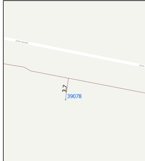
La Imagen N° 5 corresponde a la ciudad de Pacasmayo, en calle Ancash cuadra 4. En campo, se identificó que la longitud total de la tubería de conexión es de 2,95 m. (lo cual considera el ancho de la vereda, distancia al eje de la red común, altura de la vereda, altura al gabinete y profundidad de la tubería) y la empresa al reportar su información en el procedimiento VNRGN, para la misma tubería de conexión reportó 3,7 m.
