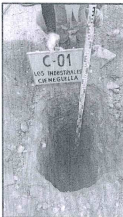
Foto N° 02.- Tomas del interior de la calicata C-1. Superficialmente se aprecia una capa de relleno contaminado, bajo el cual subyace, hasta la profundidad explorada de 1.50m un único estrato arenoso con apreciable contenido de gravas y con presencia de bolonería.
