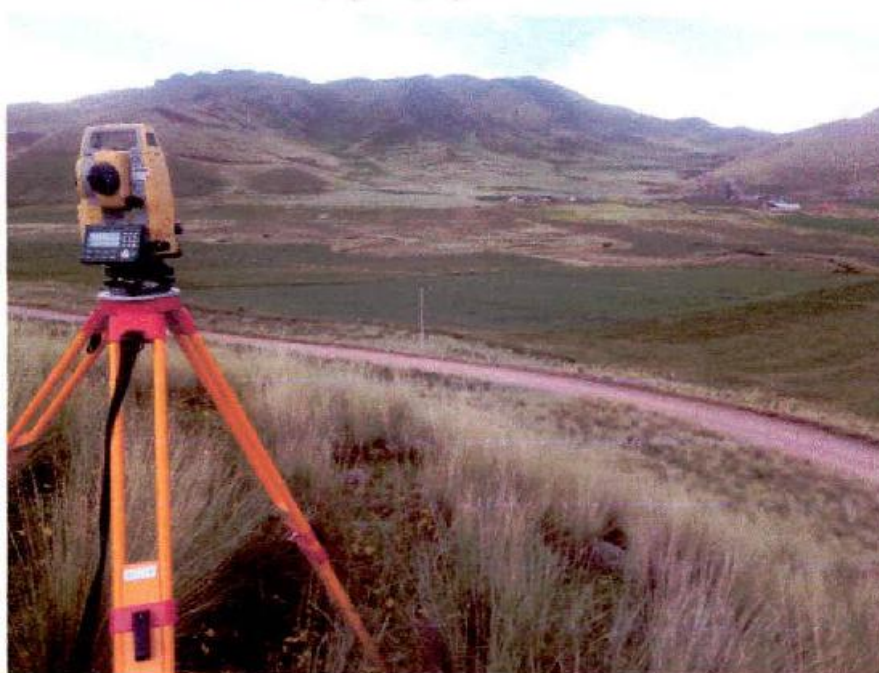
Foto 08: Equipo topográfico Estación 3 en BM-5 pintado sobre roca sólido.
