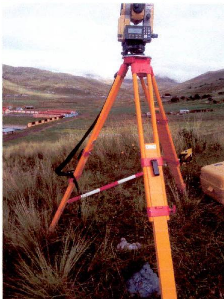
Foto 08: Equipo topográfico Estación 3 en BM-5 pintado sobre roca sólido.
