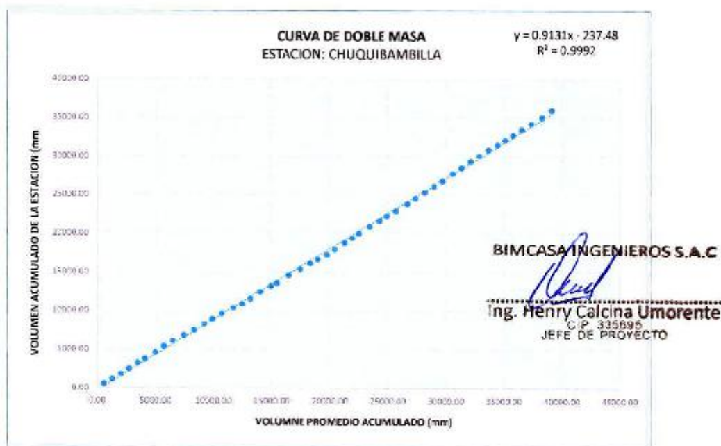
Figura III- 13: Análisis de Doble Masa de la Estación Chuquibambilla
