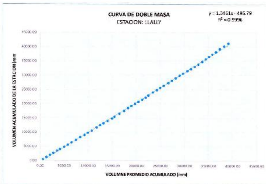
Figura III- 12: Análisis de Doble Masa de la Estación Llally
