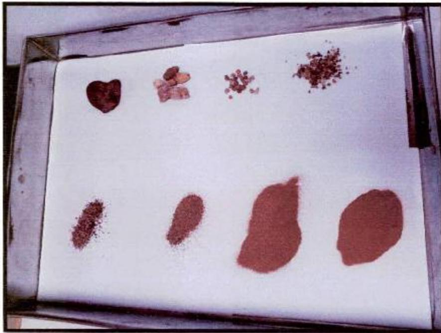
**FOTOGRAFÍA 47.** C - 11, Se visualiza el ensayo de análisis granulométrico de la E-02 realizado por los diferentes tamices, Proyecto "MEJORAMIENTO DEL SERVICIO DE AGUA PARA RIEGO DEL SISTEMA DE RIEGO DEL COMITÉ DE REGANTES ACOYO FRONTIS DEL DISTRITO DE CUPI, PROVINCIA DE MELGAR - PUNO"
