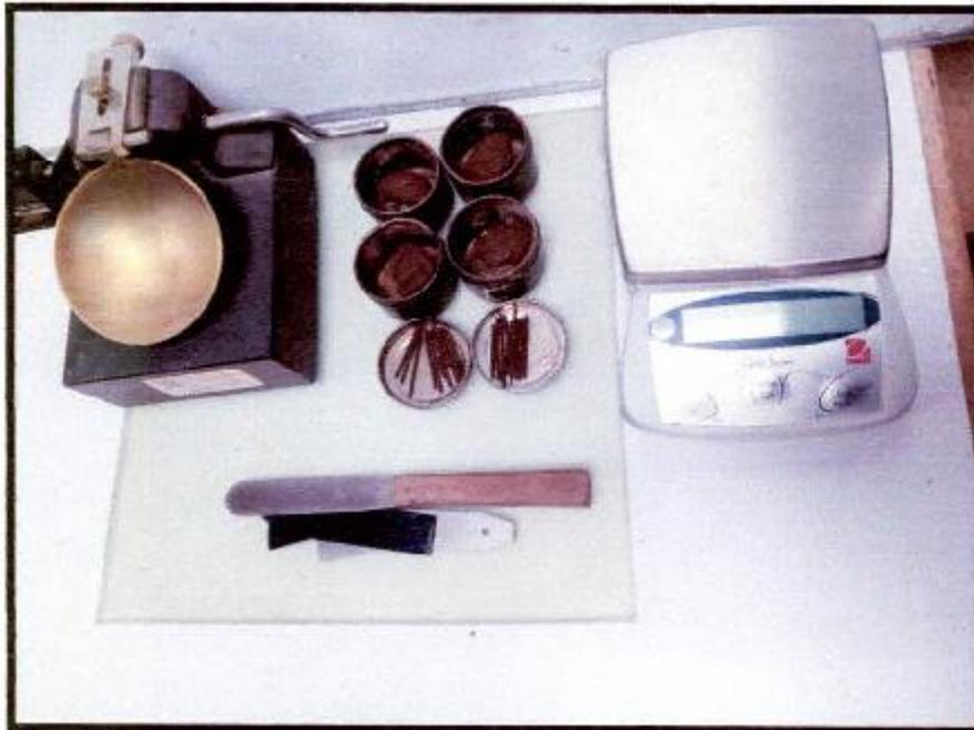
FOTOGRAFÍA 54. C - 02, Se visualiza el ensayo de análisis de límites de consistencia de la E-02 realizado por los diferentes tamices, Proyecto "MEJORAMIENTO DEL SERVICIO DE AGUA PARA RIEGO DEL SISTEMA DE RIEGO DEL COMITÉ DE REGANTES ACOYO FRONTIS DEL DISTRITO DE CUPI, PROVINCIA DE MELGAR - PUNO"
