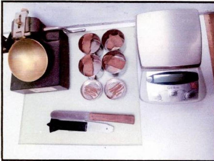
**FOTOGRAFÍA 60.** C - 05, Se visualiza el ensayo de análisis de límites de consistencia de la E-02 realizado por los diferentes tamices, Proyecto "MEJORAMIENTO DEL SERVICIO DE AGUA PARA RIEGO DEL SISTEMA DE RIEGO DEL COMITÉ DE REGANTES ACOYO FRONTIS DEL DISTRITO DE CUPI, PROVINCIA DE MELGAR - PUNO"
