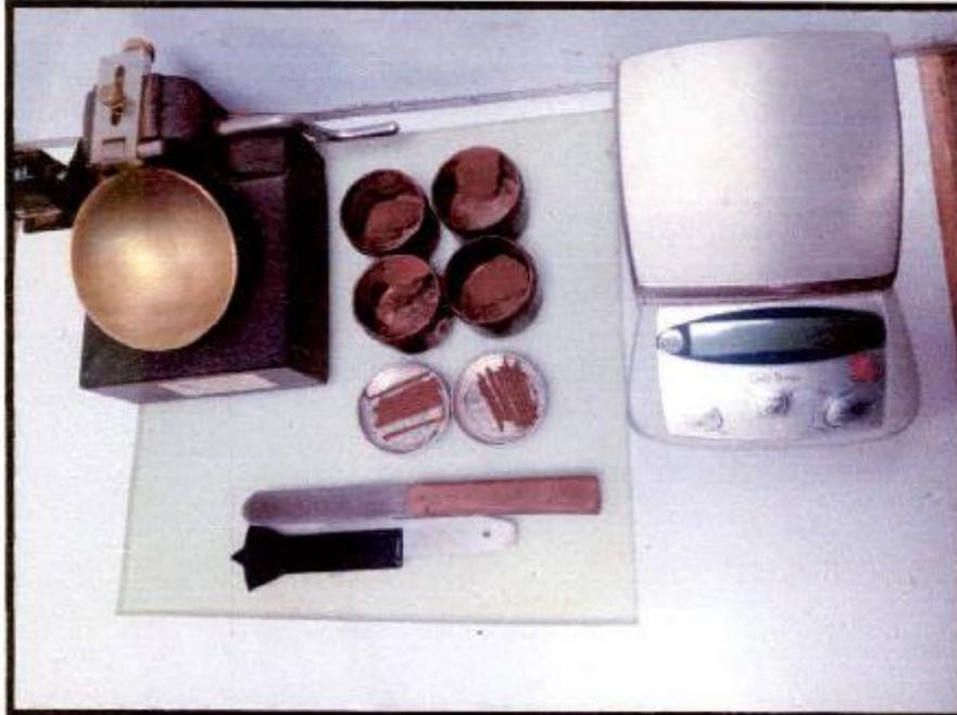
**FOTOGRAFÍA 66.** C - 08, Se visualiza el ensayo de análisis de límites de consistencia de la E-02 realizado por los diferentes tamices, Proyecto "MEJORAMIENTO DEL SERVICIO DE AGUA PARA RIEGO DEL SISTEMA DE RIEGO DEL COMITÉ DE REGANTES ACOYO FRONTIS DEL DISTRITO DE CUPI, PROVINCIA DE MELGAR - PUNO"
