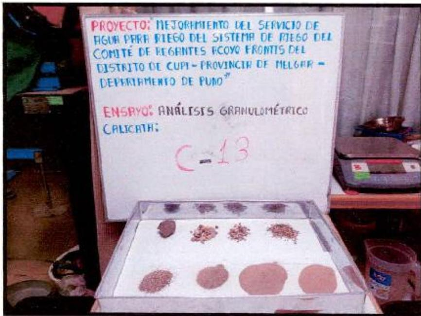
**FOTOGRAFÍA 50.** C - 13, Se visualiza el ensayo de análisis granulométrico de la E-02 realizado por los diferentes tamices, Proyecto "MEJORAMIENTO DEL SERVICIO DE AGUA PARA RIEGO DEL SISTEMA DE RIEGO DEL COMITÉ DE REGANTES ACOYO FRONTIS DEL DISTRITO DE CUPI, PROVINCIA DE MELGAR - PUNO"
