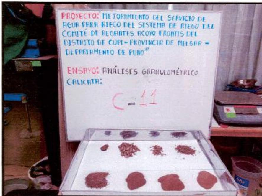
**FOTOGRAFÍA 48.** C - 11, Se visualiza el ensayo de análisis granulométrico de la E-02 realizado por los diferentes tamices, Proyecto "MEJORAMIENTO DEL SERVICIO DE AGUA PARA RIEGO DEL SISTEMA DE RIEGO DEL COMITÉ DE REGANTES ACOYO FRONTIS DEL DISTRITO DE CUPI, PROVINCIA DE MELGAR - PUNO"
