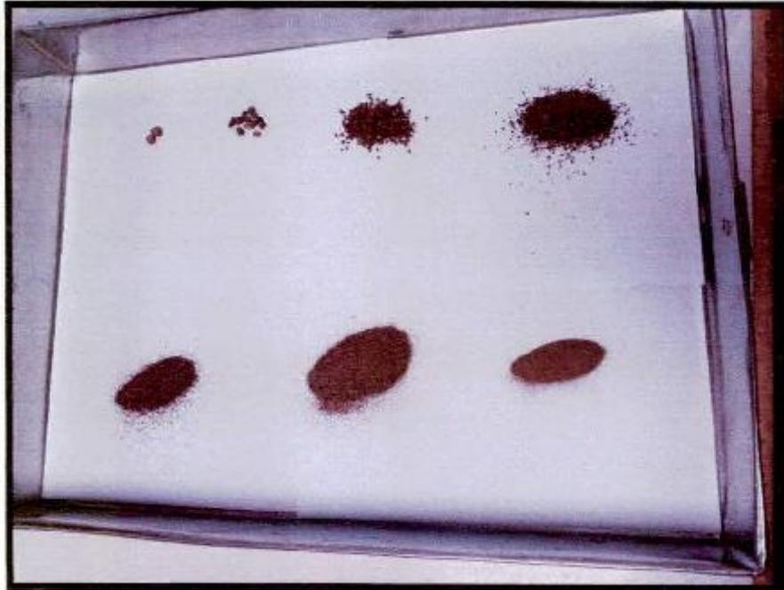
**FOTOGRAFÍA 33.** C - 04, Se visualiza el ensayo de análisis granulométrico de la E-02 realizado por los diferentes tamices, Proyecto "MEJORAMIENTO DEL SERVICIO DE AGUA PARA RIEGO DEL SISTEMA DE RIEGO DEL COMITÉ DE REGANTES ACOYO FRONTIS DEL DISTRITO DE CUPI, PROVINCIA DE MELGAR - PUNO"
