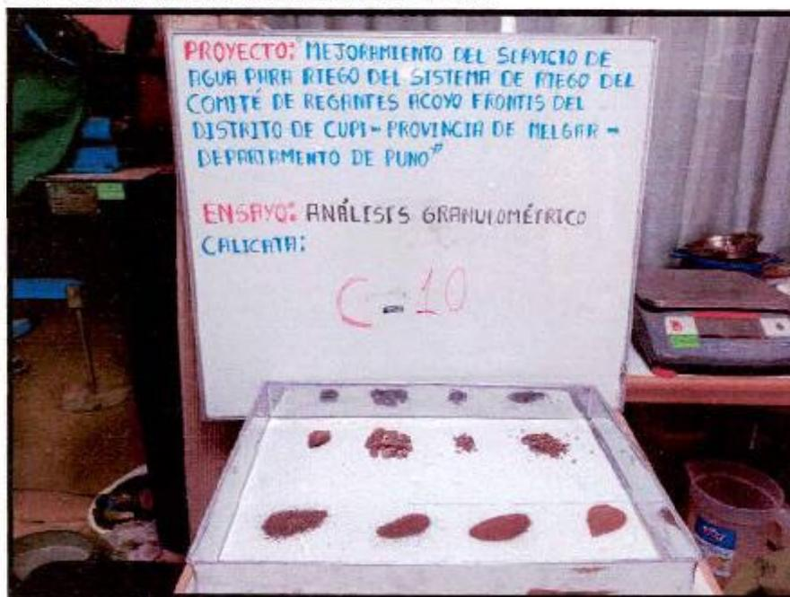
**FOTOGRAFÍA 46.** C - 10, Se visualiza el ensayo de análisis granulométrico de la E-02 realizado por los diferentes tamices, Proyecto "MEJORAMIENTO DEL SERVICIO DE AGUA PARA RIEGO DEL SISTEMA DE RIEGO DEL COMITÉ DE REGANTES ACOYO FRONTIS DEL DISTRITO DE CUPI, PROVINCIA DE MELGAR - PUNO"
