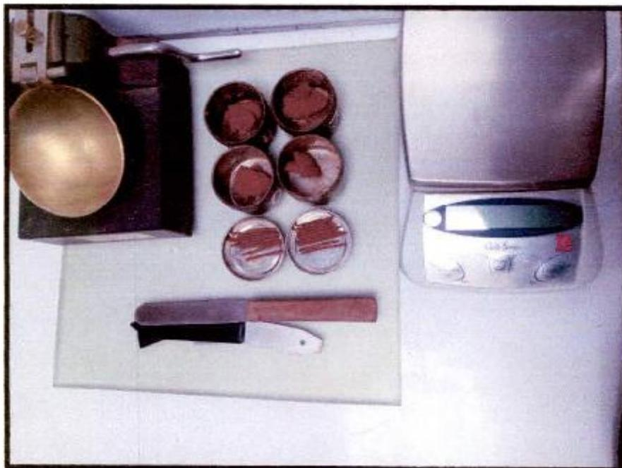
**FOTOGRAFÍA 64.** C - 07, Se visualiza el ensayo de análisis de límites de consistencia de la E-02 realizado por los diferentes tamices, Proyecto "MEJORAMIENTO DEL SERVICIO DE AGUA PARA RIEGO DEL SISTEMA DE RIEGO DEL COMITÉ DE REGANTES ACOYO FRONTIS DEL DISTRITO DE CUPI, PROVINCIA DE MELGAR - PUNO"
