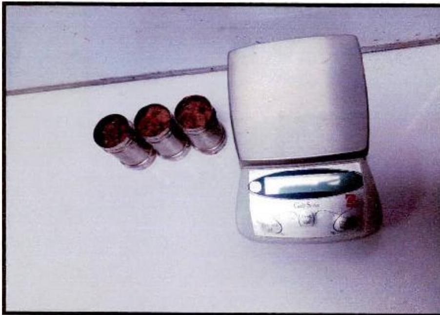
**FOTOGRAFÍA 26.** C - 13, Visualización del Ensayo de contenido de humedad del estrato 02 después del secado en el horno, Proyecto "MEJORAMIENTO DEL SERVICIO DE AGUA PARA RIEGO DEL SISTEMA DE RIEGO DEL COMITÉ DE REGANTES ACOYO FRONTIS DEL DISTRITO DE CUPI, PROVINCIA DE MELGAR - PUNO"
