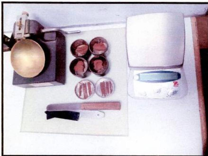
FOTOGRAFÍA 70. C - 10, Se visualiza el ensayo de análisis de límites de consistencia de la E-02 realizado por los diferentes tamices, Proyecto "MEJORAMIENTO DEL SERVICIO DE AGUA PARA RIEGO DEL SISTEMA DE RIEGO DEL COMITÉ DE REGANTES ACOYO FRONTIS DEL DISTRITO DE CUPI, PROVINCIA DE MELGAR - PUNO"
