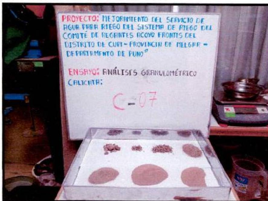
**FOTOGRAFÍA 40.** C - 07, Se visualiza el ensayo de análisis granulométrico de la E-02 realizado por los diferentes tamices, Proyecto "MEJORAMIENTO DEL SERVICIO DE AGUA PARA RIEGO DEL SISTEMA DE RIEGO DEL COMITÉ DE REGANTES ACOYO FRONTIS DEL DISTRITO DE CUPI, PROVINCIA DE MELGAR - PUNO"
