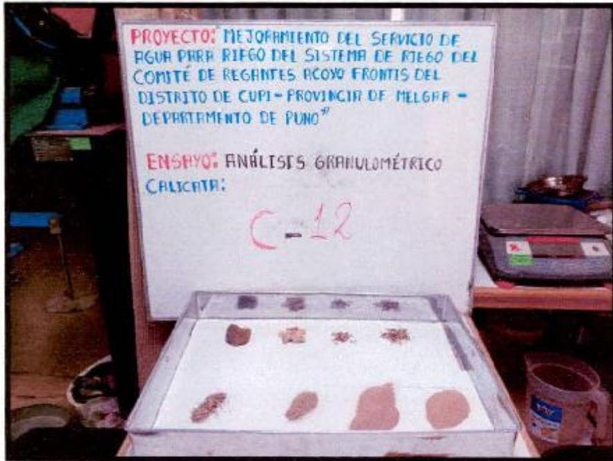
**FOTOGRAFÍA 49.** C - 12, Se visualiza el ensayo de análisis granulométrico de la E-02 realizado por los diferentes tamices, Proyecto "MEJORAMIENTO DEL SERVICIO DE AGUA PARA RIEGO DEL SISTEMA DE RIEGO DEL COMITÉ DE REGANTES ACOYO FRONTIS DEL DISTRITO DE CUPI, PROVINCIA DE MELGAR - PUNO"
