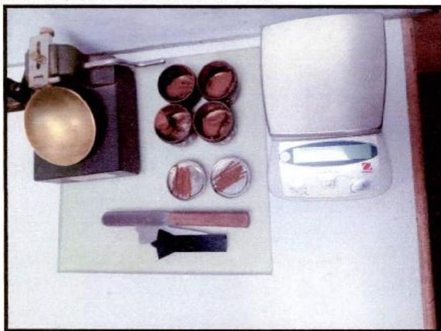
**FOTOGRAFÍA 74.** C - 12, Se visualiza el ensayo de análisis de límites de consistencia de la E-02 realizado por los diferentes tamices, Proyecto "MEJORAMIENTO DEL SERVICIO DE AGUA PARA RIEGO DEL SISTEMA DE RIEGO DEL COMITÉ DE REGANTES ACOYO FRONTIS DEL DISTRITO DE CUPI, PROVINCIA DE MELGAR - PUNO"
