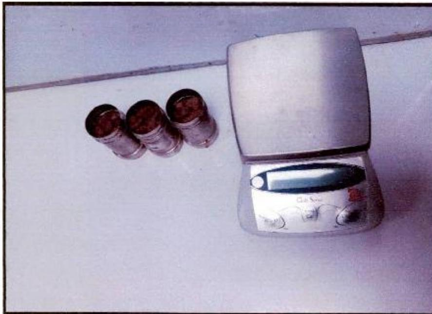
**FOTOGRAFÍA 24.** C - 12, Visualización del Ensayo de contenido de humedad del estrato 02 después del secado en el horno, Proyecto "MEJORAMIENTO DEL SERVICIO DE AGUA PARA RIEGO DEL SISTEMA DE RIEGO DEL COMITÉ DE REGANTES ACOYO FRONTIS DEL DISTRITO DE CUPI, PROVINCIA DE MELGAR - PUNO"
