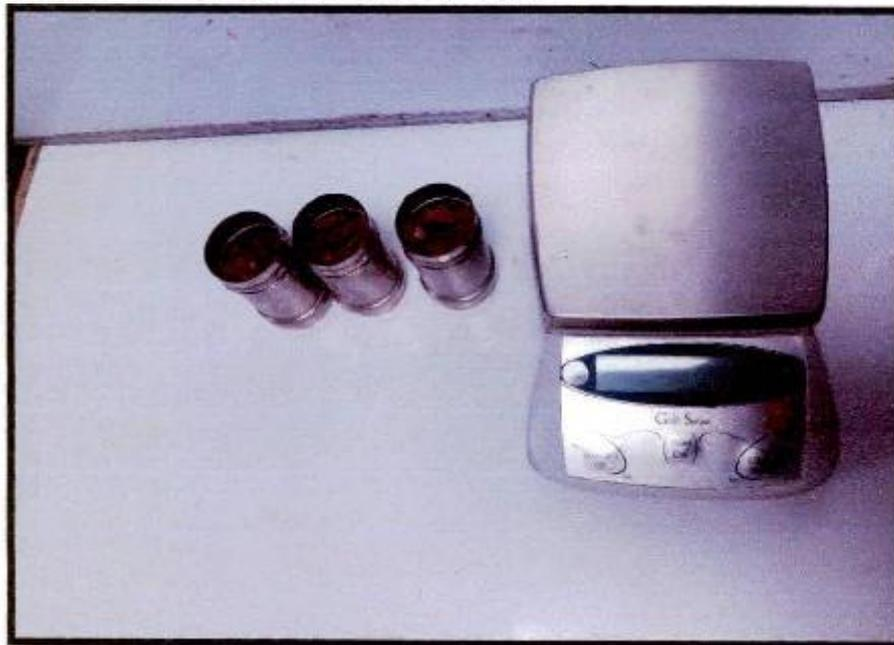
**FOTOGRAFÍA 22.** C - 11, Visualización del Ensayo de contenido de humedad del estrato 02 después del secado en el horno, Proyecto "MEJORAMIENTO DEL SERVICIO DE AGUA PARA RIEGO DEL SISTEMA DE RIEGO DEL COMITÉ DE REGANTES ACOYO FRONTIS DEL DISTRITO DE CUPI, PROVINCIA DE MELGAR - PUNO"
