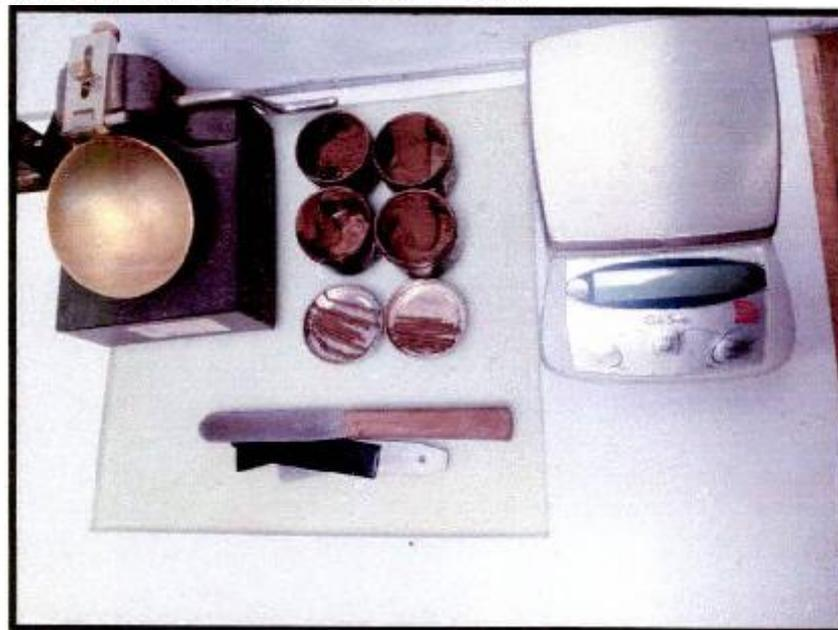
**FOTOGRAFÍA 52.** C - 01, Se visualiza el ensayo de análisis de límites de consistencia de la E-02 realizado por los diferentes tamices. Proyecto "MEJORAMIENTO DEL SERVICIO DE AGUA PARA RIEGO DEL SISTEMA DE RIEGO DEL COMITÉ DE REGANTES ACOYO FRONTIS DEL DISTRITO DE CUPI, PROVINCIA DE MELGAR - PUNO"
