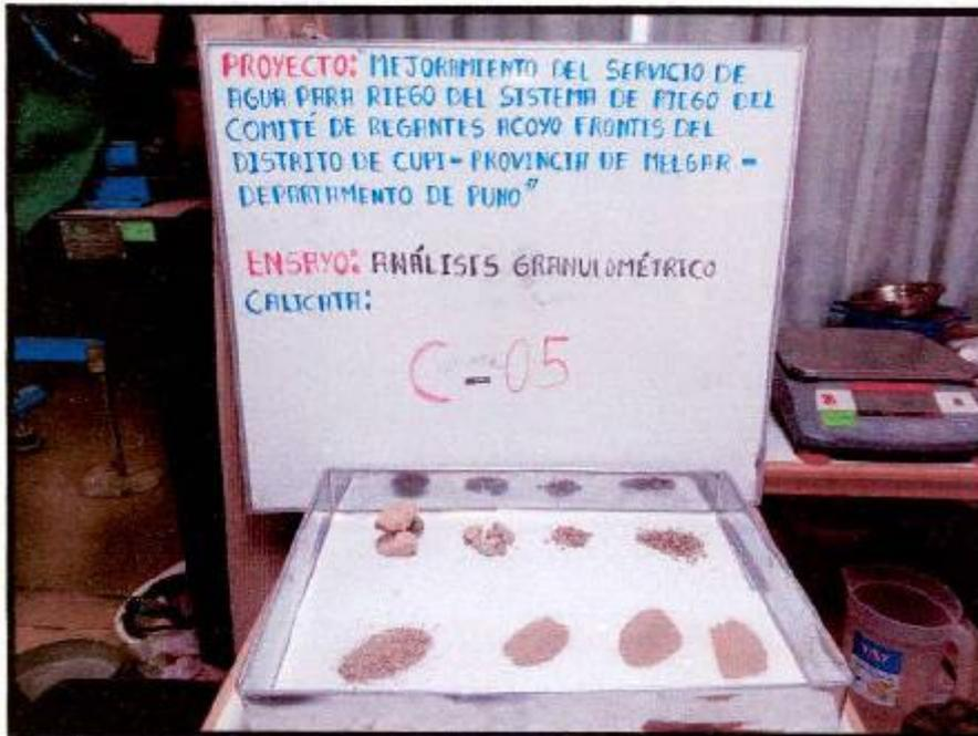
**FOTOGRAFÍA 36.** C - 05, Se visualiza el ensayo de análisis granulométrico de la E-02 realizado por los diferentes tamices, Proyecto "MEJORAMIENTO DEL SERVICIO DE AGUA PARA RIEGO DEL SISTEMA DE RIEGO DEL COMITÉ DE REGANTES ACOYO FRONTIS DEL DISTRITO DE CUPI, PROVINCIA DE MELGAR - PUNO"
