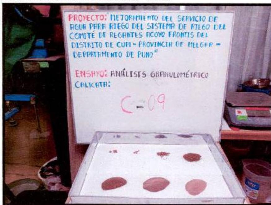
**FOTOGRAFÍA 44.** C - 09, Se visualiza el ensayo de análisis granulométrico de la E-02 realizado por los diferentes tamices, Proyecto "MEJORAMIENTO DEL SERVICIO DE AGUA PARA RIEGO DEL SISTEMA DE RIEGO DEL COMITÉ DE REGANTES ACOYO FRONTIS DEL DISTRITO DE CUPI, PROVINCIA DE MELGAR - PUNO"
