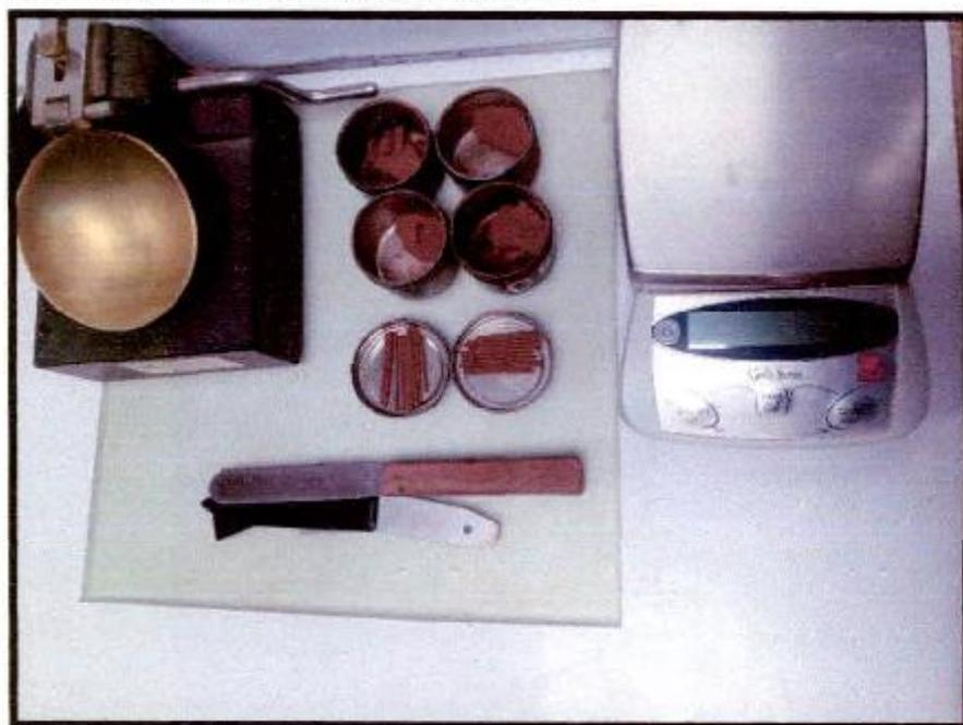
**FOTOGRAFÍA 72.** C - 11, Se visualiza el ensayo de análisis de límites de consistencia de la E-02 realizado por los diferentes tamices, Proyecto "MEJORAMIENTO DEL SERVICIO DE AGUA PARA RIEGO DEL SISTEMA DE RIEGO DEL COMITÉ DE REGANTES ACOYO FRONTIS DEL DISTRITO DE CUPI, PROVINCIA DE MELGAR - PUNO"
