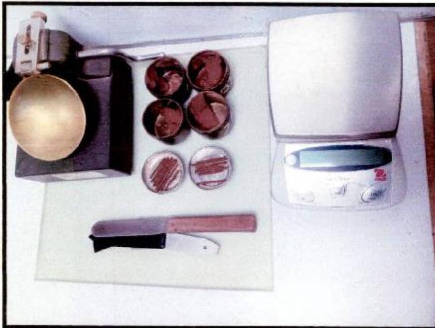
**FOTOGRAFÍA 68.** C - 09, Se visualiza el ensayo de análisis de límites de consistencia de la E-02 realizado por los diferentes tamices, Proyecto "MEJORAMIENTO DEL SERVICIO DE AGUA PARA RIEGO DEL SISTEMA DE RIEGO DEL COMITÉ DE REGANTES ACOYO FRONTIS DEL DISTRITO DE CUPI, PROVINCIA DE MELGAR - PUNO"
