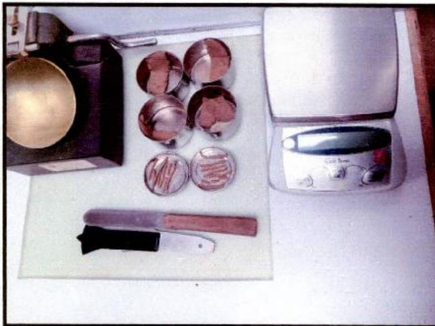
**FOTOGRAFÍA 62.** C - 06, Se visualiza el ensayo de análisis de límites de consistencia de la E-02 realizado por los diferentes tamices, Proyecto "MEJORAMIENTO DEL SERVICIO DE AGUA PARA RIEGO DEL SISTEMA DE RIEGO DEL COMITÉ DE REGANTES ACOYO FRONTIS DEL DISTRITO DE CUPI, PROVINCIA DE MELGAR - PUNO"
