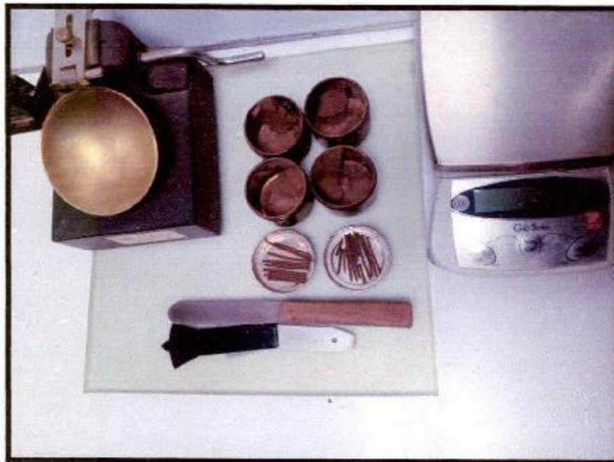
**FOTOGRAFÍA 56.** C - 03, Se visualiza el ensayo de análisis de límites de consistencia de la E-02 realizado por los diferentes tamices, Proyecto "MEJORAMIENTO DEL SERVICIO DE AGUA PARA RIEGO DEL SISTEMA DE RIEGO DEL COMITÉ DE REGANTES ACOYO FRONTIS DEL DISTRITO DE CUPI, PROVINCIA DE MELGAR - PUNO"
