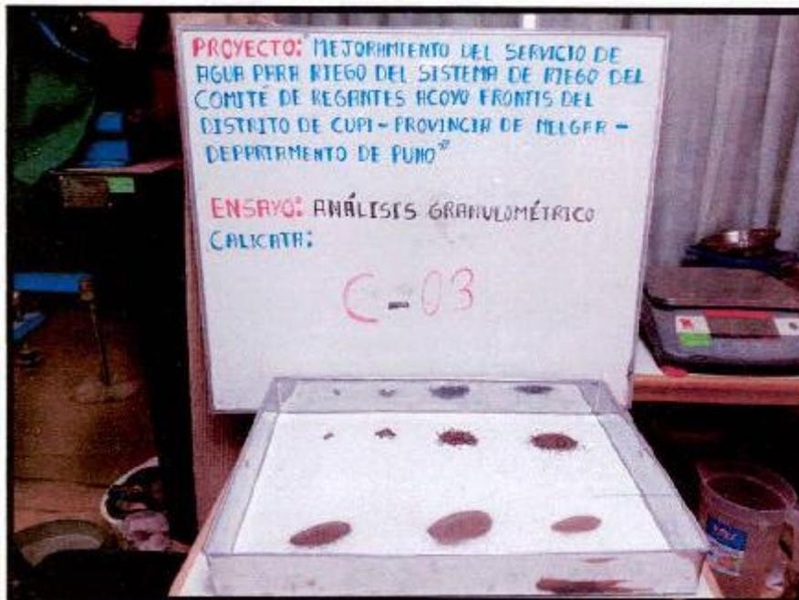
**FOTOGRAFÍA 32.** C - 03, Se visualiza el ensayo de análisis granulométrico de la E-02 realizado por los diferentes tamices, Proyecto "MEJORAMIENTO DEL SERVICIO DE AGUA PARA RIEGO DEL SISTEMA DE RIEGO DEL COMITÉ DE REGANTES ACOYO FRONTIS DEL DISTRITO DE CUPI, PROVINCIA DE MELGAR - PUNO"
