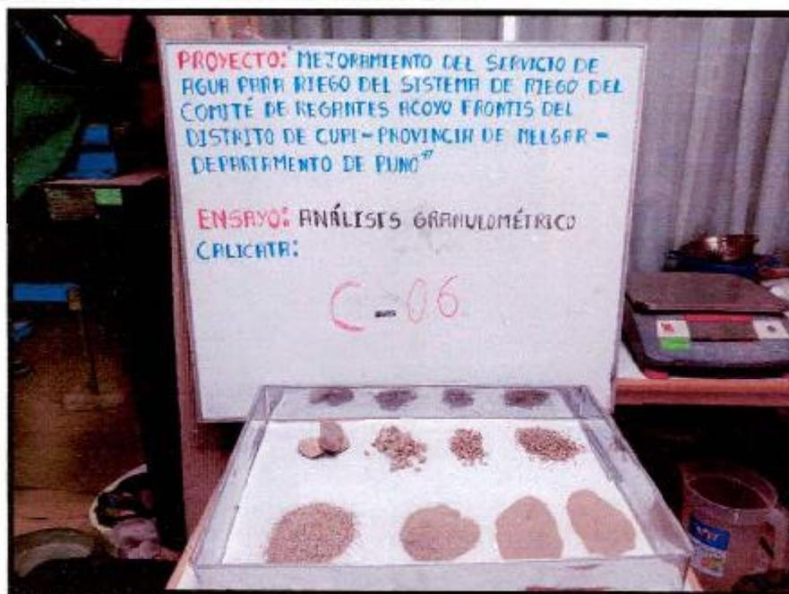
FOTOGRAFÍA 38. C - 06, Se visualiza el ensayo de análisis granulométrico de la E-02 realizado por los diferentes tamices, Proyecto "MEJORAMIENTO DEL SERVICIO DE AGUA PARA RIEGO DEL SISTEMA DE RIEGO DEL COMITÉ DE REGANTES ACOYO FRONTIS DEL DISTRITO DE CUPI, PROVINCIA DE MELGAR - PUNO"
