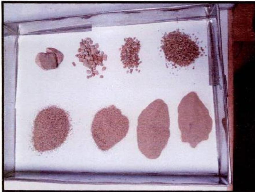
**FOTOGRAFÍA 35.** C - 05, Se visualiza el ensayo de análisis granulométrico de la E-02 realizado por los diferentes tamices, Proyecto "MEJORAMIENTO DEL SERVICIO DE AGUA PARA RIEGO DEL SISTEMA DE RIEGO DEL COMITÉ DE REGANTES ACOYO FRONTIS DEL DISTRITO DE CUPI, PROVINCIA DE MELGAR - PUNO"
