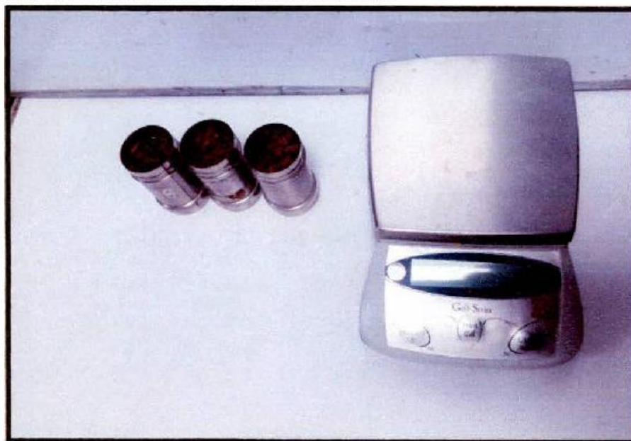
FOTOGRAFÍA 18. C - 09, Visualización del Ensayo de contenido de humedad del estrato 02 después del secado en el horno, Proyecto "MEJORAMIENTO DEL SERVICIO DE AGUA PARA RIEGO DEL SISTEMA DE RIEGO DEL COMITÉ DE REGANTES ACOYO FRONTIS DEL DISTRITO DE CUPI, PROVINCIA DE MELGAR - PUNO"
