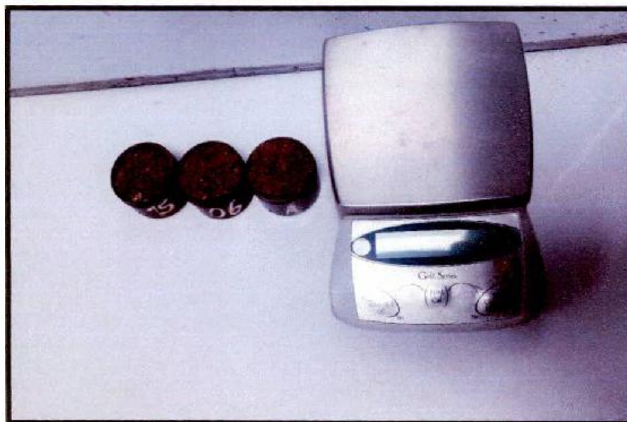
FOTOGRAFÍA 10. C - 17, Visualización del Ensayo de contenido de humedad del estrato 02 después del secado en el horno, Proyecto "MEJORAMIENTO DEL SERVICIO DE AGUA PARA RIEGO DEL SISTEMA DE RIEGO DEL COMITÉ DE REGANTES ACOYO FRONTIS DEL DISTRITO DE CUPI, PROVINCIA DE MELGAR - PUNO"
