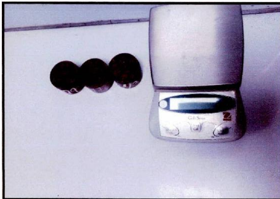
FOTOGRAFÍA 14. C - 07, Visualización del Ensayo de contenido de humedad del estrato 02 después del secado en el horno, Proyecto "MEJORAMIENTO DEL SERVICIO DE AGUA PARA RIEGO DEL SISTEMA DE RIEGO DEL COMITÉ DE REGANTES ACOYO FRONTIS DEL DISTRITO DE CUPI, PROVINCIA DE MELGAR - PUNO"
