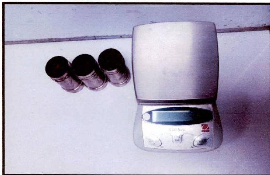
FOTOGRAFÍA 06. C - 03, Visualización del Ensayo de contenido de humedad del estrato 02 después del secado en el horno, Proyecto "MEJORAMIENTO DEL SERVICIO DE AGUA PARA RIEGO DEL SISTEMA DE RIEGO DEL COMITÉ DE REGANTES ACOYO FRONTIS DEL DISTRITO DE CUPI, PROVINCIA DE MELGAR - PUNO".
