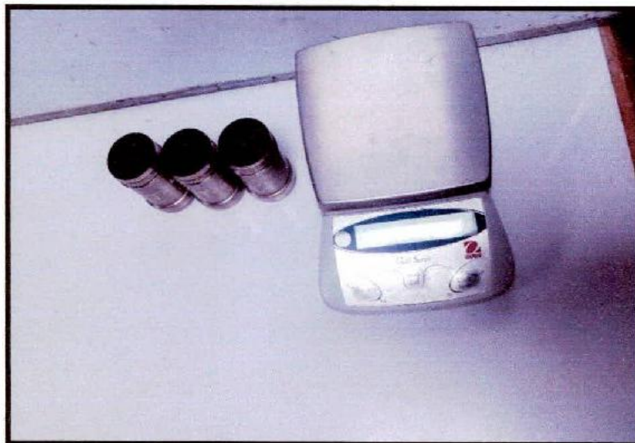
FOTOGRAFÍA 08. C - 4, Visualización del Ensayo de contenido de humedad del estrato 02 después del secado en el horno, Proyecto "MEJORAMIENTO DEL SERVICIO DE AGUA PARA RIEGO DEL SISTEMA DE RIEGO DEL COMITÉ DE REGANTES ACOYO FRONTIS DEL DISTRITO DE CUPI, PROVINCIA DE MELGAR - PUNO"
