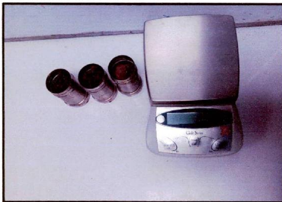
FOTOGRAFÍA 16. C – 08, Visualización del Ensayo de contenido de humedad del estrato 02 después del secado en el horno, Proyecto “MEJORAMIENTO DEL SERVICIO DE AGUA PARA RIEGO DEL SISTEMA DE RIEGO DEL COMITÉ DE REGANTES ACOYO FRONTIS DEL DISTRITO DE CUPI, PROVINCIA DE MELGAR - PUNO”
