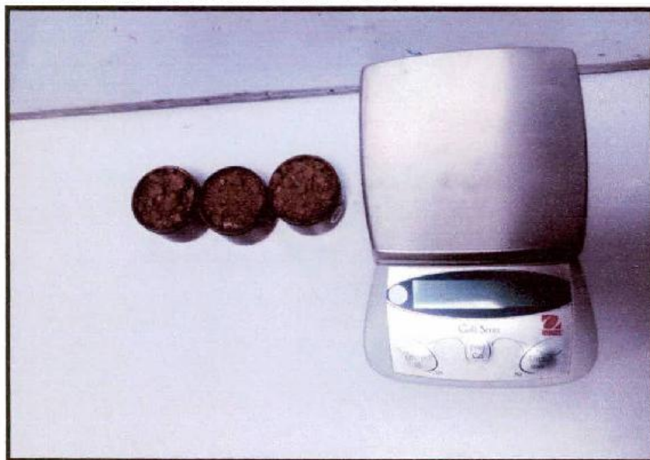
FOTOGRAFÍA 12. C - 06, Visualización del Ensayo de contenido de humedad del estrato 02 después del secado en el horno, Proyecto "MEJORAMIENTO DEL SERVICIO DE AGUA PARA RIEGO DEL SISTEMA DE RIEGO DEL COMITÉ DE REGANTES ACOYO FRONTIS DEL DISTRITO DE CUPI, PROVINCIA DE MELGAR - PUNO"
