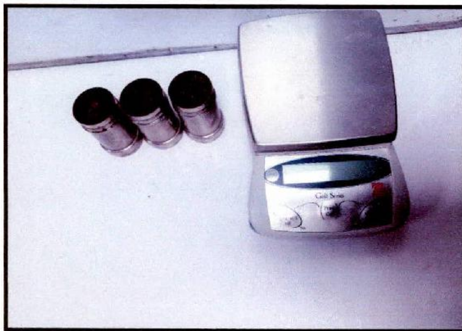
FOTOGRAFÍA 20. C - 10, Visualización del Ensayo de contenido de humedad del estrato 03 después del secado en el horno, Proyecto "MEJORAMIENTO DEL SERVICIO DE AGUA PARA RIEGO DEL SISTEMA DE RIEGO DEL COMITÉ DE REGANTES ACOYO FRONTIS DEL DISTRITO DE CUPI, PROVINCIA DE MELGAR - PUNO"
