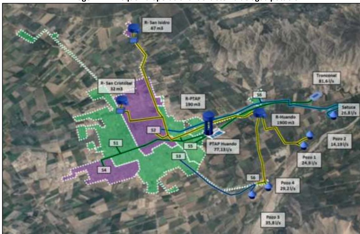
Imagen N° 7: Esquema operacional del sistema de agua potable
